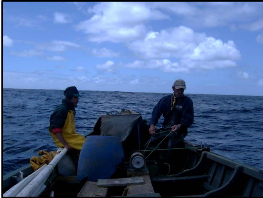
**Figura 4.** Fotografía de pequeño torno hidráulico llamado “chigre”. Este chigre es utilizado en la pesquería de langosta para reducir el tiempo de manipulación de las trampas.
