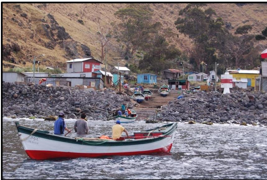
**Figura 1.** Fotografía de embarcación utilizada en Archipiélago de Juan Fernández “chalupas de mar”. Bote de doble proa, de entre 8 y 10 metros de eslora, con motor fuera de borda. En la imagen se observa a los pescadores en la maniobra de varado de botes a la caleta del poblado Rada de la Colonia en isla Alejandro Selkirk.
